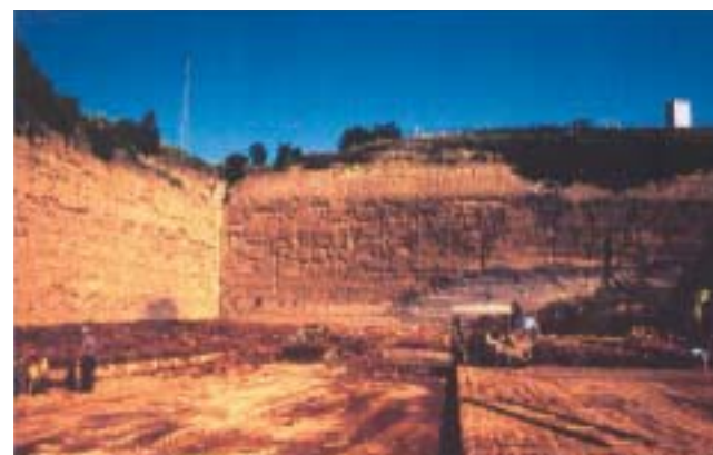
Figura 3. Extracción de tufo zeolítico de una cantera para obtener bloques. En el centro puede verse el corte que se forma al sacar los bloques.
